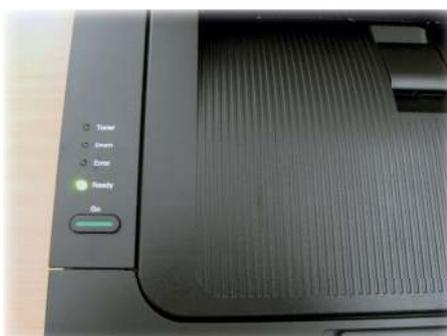
Wenn Sie nun die Go-Taste drücken, druckt das Gerät eine Testseite aus. Vergewissern Sie sich, dass die Testseite korrekt gedruckt wurde.
