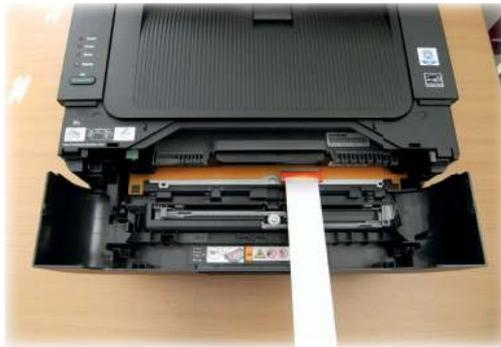
Nehmen Sie die Trommeleinheit mit der Tonerkassette heraus und schwenken Sie sie mehrmals hin und her um den Toner gleichmäßig zu verteilen. Danach setzen Sie die Trommeleinheit wieder in das Gerät ein. Ist die Einheit richtig eingerastet, hört man ein Klicken. Schließen Sie die vordere Abdeckung wieder.
