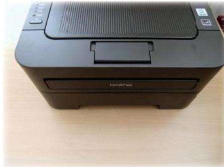
Um die Funktionalität des Drucker zu überprüfen, drucken Sie bitte eine Testseite. Dazu schließen Sie bitte das Stromkabel am Gerät an und stecken den Netzstecker in die Steckdose. Schalten Sie anschließend das Gerät am Netzschalter ein.
