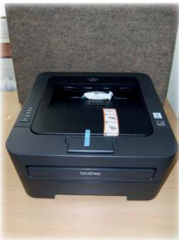
Lösen Sie den blauen Klebestreifen und öffnen Sie die vordere Abdeckung. Entfernen Sie das Gummiband von der Trommel und ziehen Sie an der Papierlasche, um das Schutzmaterial zu entfernen.
