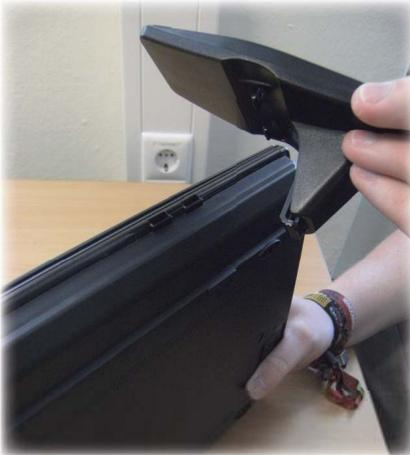
Haken Sie den Fuß in die dafür vorgesehene Vertiefung und lassen ihn einrasten. Ist der Fuß ordnungsgemäß angebracht, hören Sie ein „klicken“.
