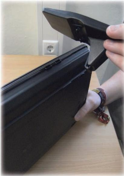
Haken Sie den Fuß in die dafür vorgesehene Vertiefung und lassen ihn einrasten. Ist der Fuß ordnungsgemäß angebracht, hören Sie ein „klicken“.
