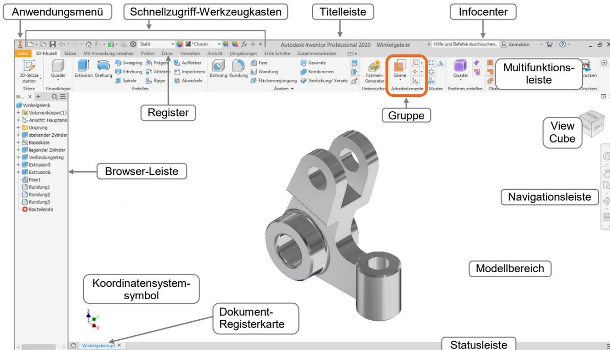
Der **Schnellzugriff-Werkzeugkasten** bietet (analog zu den Office-Anwendungen) Zugriff auf häufig benötigte Befehle, wie z. B. neue Zeichnungsdatei erstellen, Dateien öffnen, speichern und plotten.
