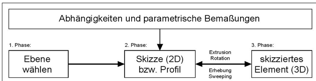
In der **1. Phase** wählen Sie eine Ebene, auf der die geplante Skizze liegen soll (eine Ebene des Koordinatensystems, eine vorhandene planare Bauteilfläche oder ein spezielles Objekt vom Typ *Arbeitsebene*). Sie wird als „SkizzierebeneQ“ bezeichnet.
