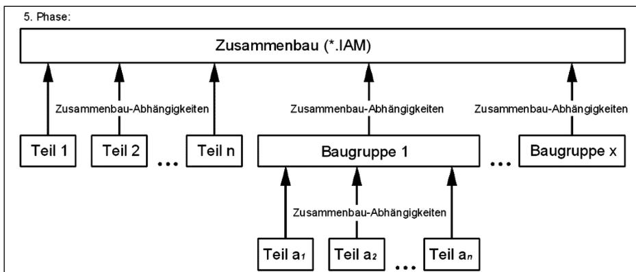
Der Zusammenbau wird in einer \*.iam- Datei gespeichert (**Inventor Assembly**).
