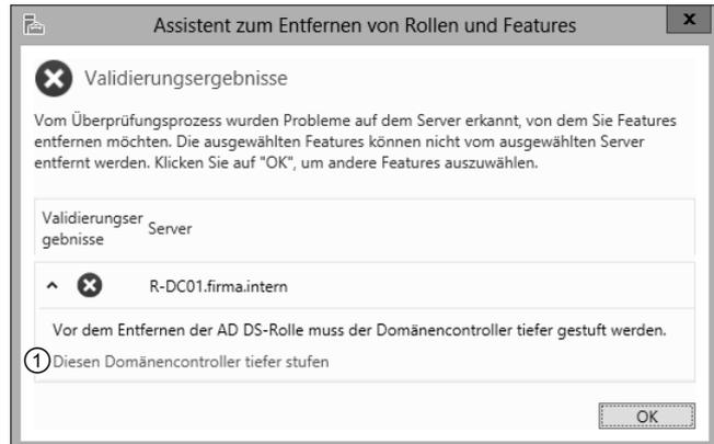
*Der DC muss tiefergestuft werden, bevor das AD entfernt werden kann*
